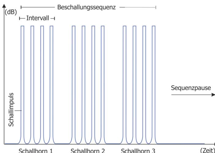
In der Regel werden zur Reinigung kurze Schallimpulse erzeugt, da Tests gezeigt haben, dass die Wirksamkeit zu Beginn jedes Schallereignisses am höchsten ist. Längere Beschallungszeiten sind jedoch bei sehr hohen Mengen an Ablagerungen sinnvoll.
