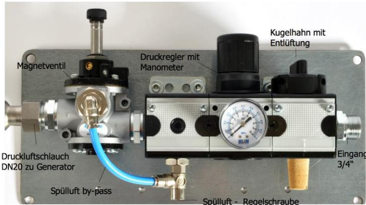
Die Druckluftwartungseinheit besteht aus einem Kugelhahn, einem Druckregler und einem 3/2-Wege-Magnetventil mit Spülluft-bypass. Vor dem Magnetventil befindet sich eine kleine Regelschraube, mit der die Menge der Kühl- und Spülluft (Umgehungsventil) eingestellt wird.
